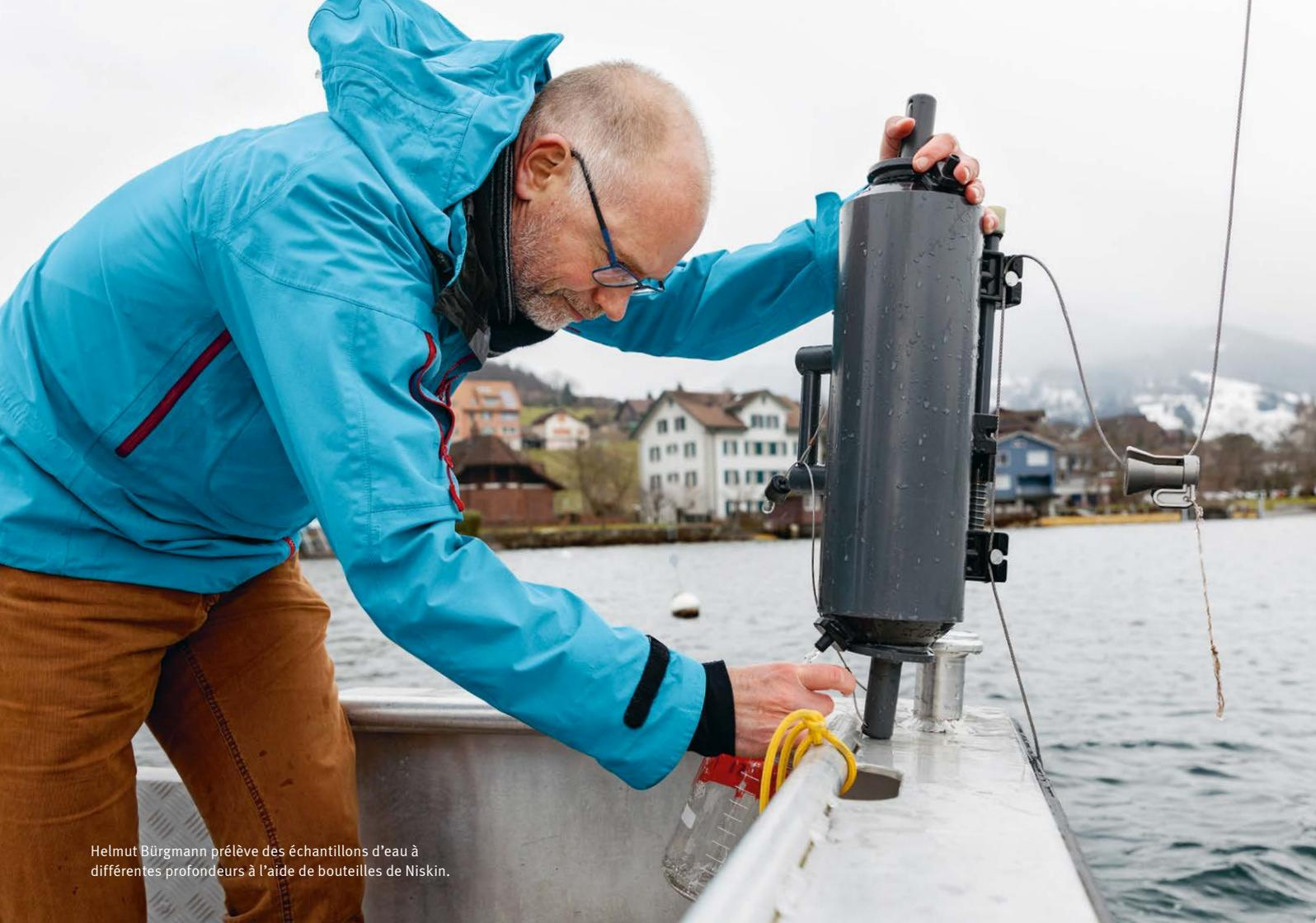
Helmut Bürgmann prélève des échantillons d'eau à différentes profondeurs à l'aide de bouteilles de Niskin.
